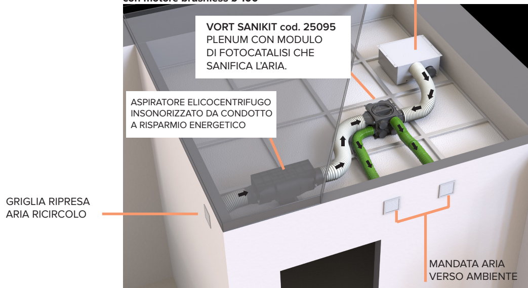
Esempio d'installazione con ventilatore da condotto con motore brushless Ø 100
