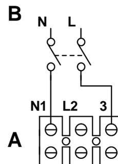
Min/max velocità - Low/high speed
