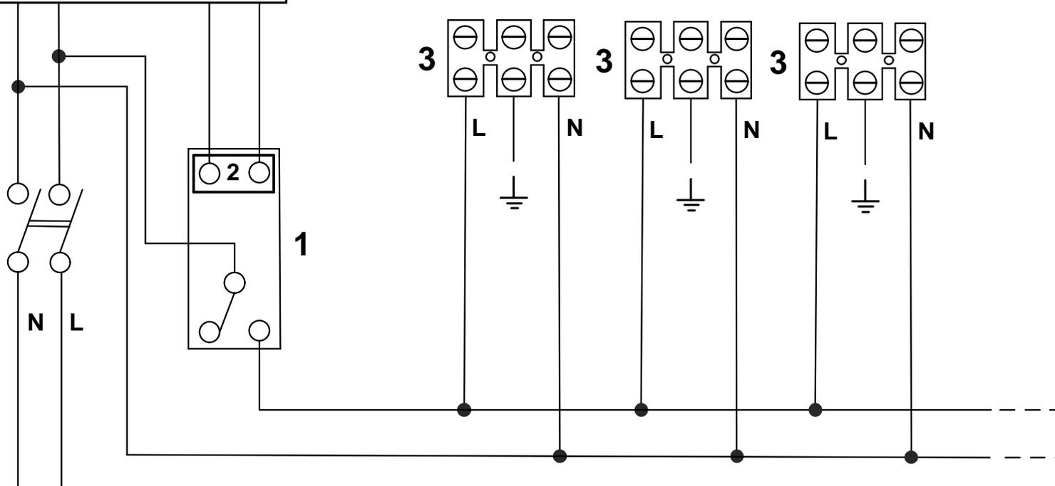
**ATTENZIONE:** Dovrà essere cura dell'installatore dimensionare opportunamente il teleruttore o il relè in funzione delle unità ad esso connesse
